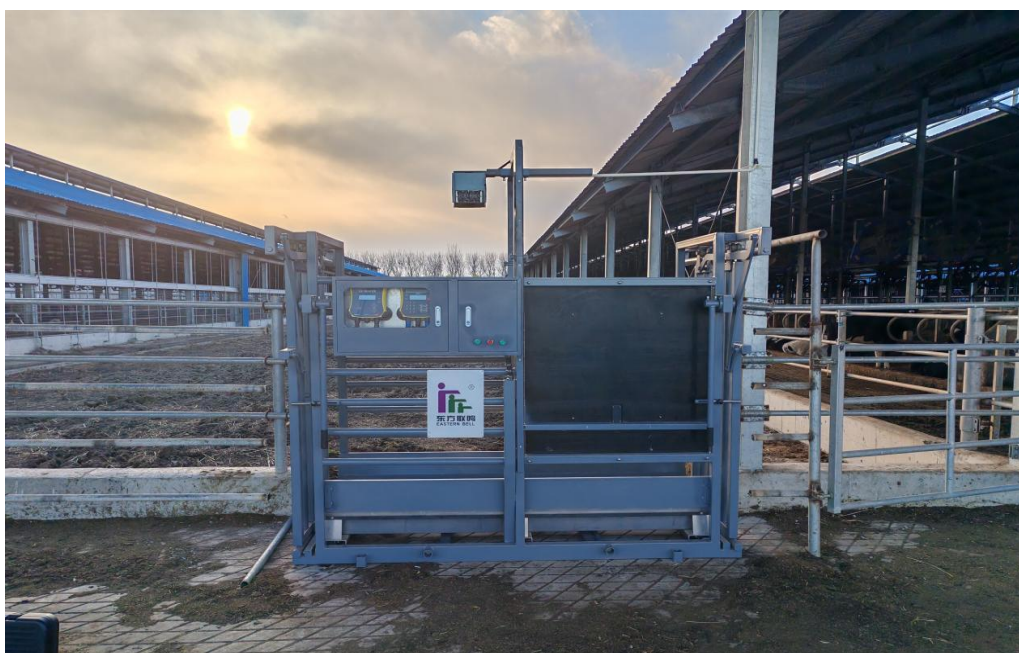
图 4 自动体重体高测量系统
